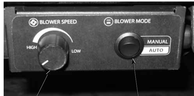
Blower Speed Control Knob (rheostat)
